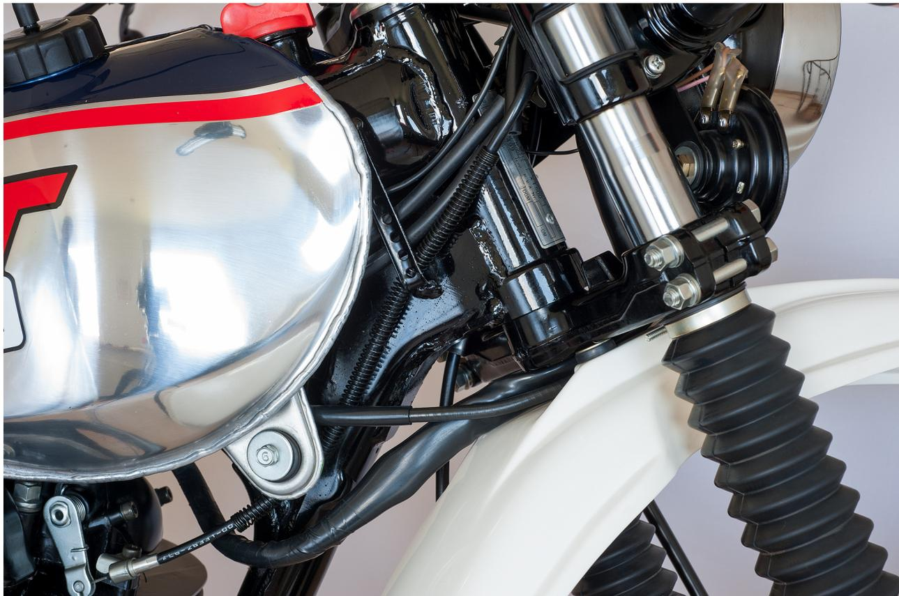
Der Kabelbaum wird zwischen der unteren Gabelbrücke und dem vorderen Kotflügel verlegt. Er wird, wie in der Abbildung zu sehen rechts am vorderen Rahmenrohr vorbei geführt, bevor er zur linken Seite führt.
