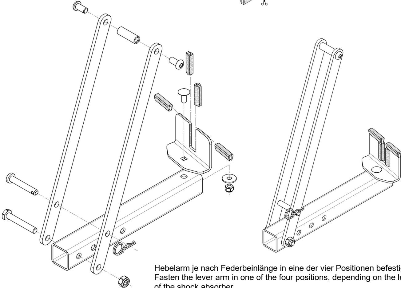
Hebelarm je nach Federbeinlänge in eine der vier Positionen befestigen /
